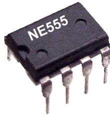
**Figura 3.11.** Circuito integrado NE555.
