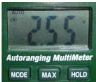
**Figura 4.24.** Voltaje registrado por el multímetro, al medir humedad.
