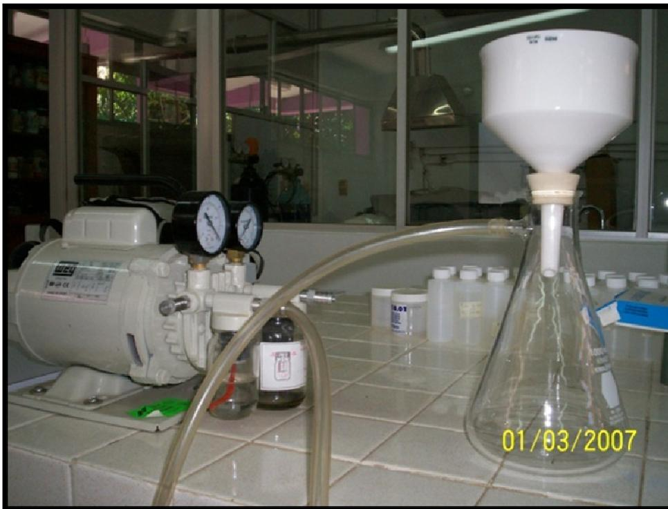
Figura 14-a. Bomba de vacío
