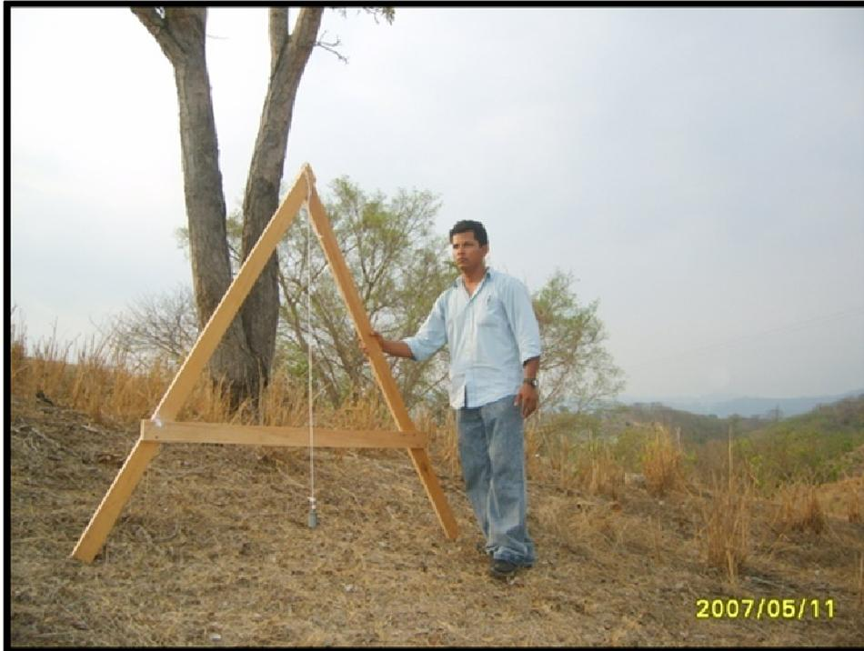
Figura 1-a. trazo de curvas a nivel en el terreno.
