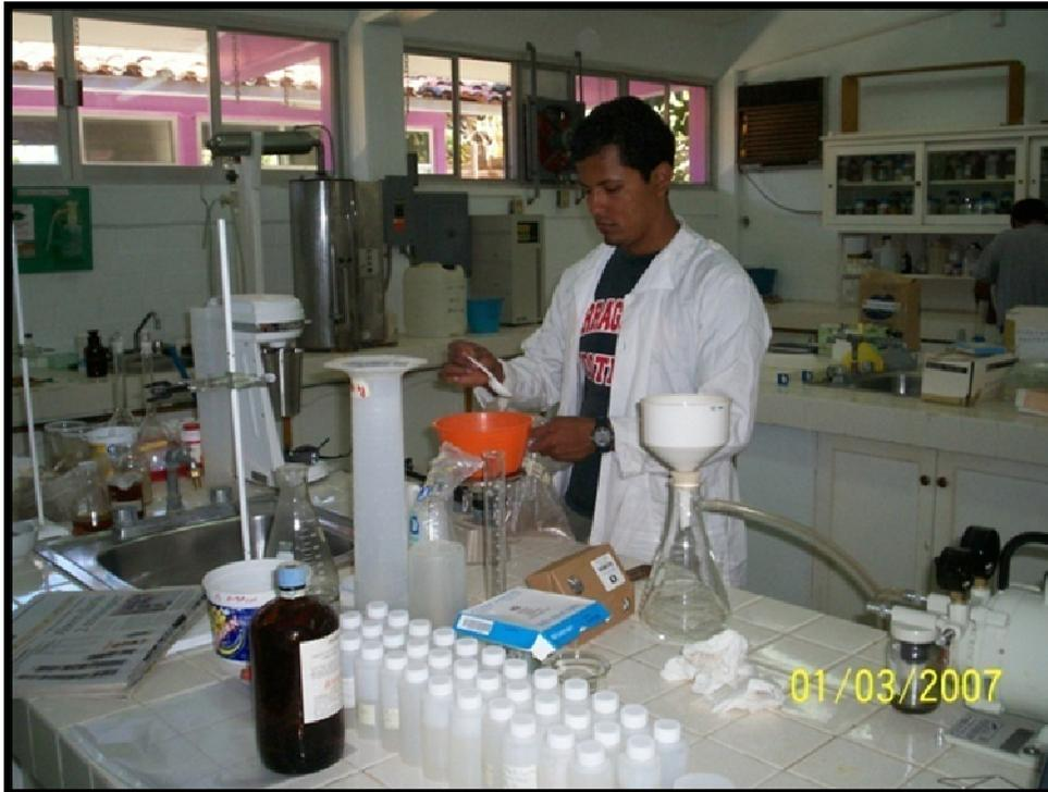
Figura 12-a. Pesando muestras de suelo
