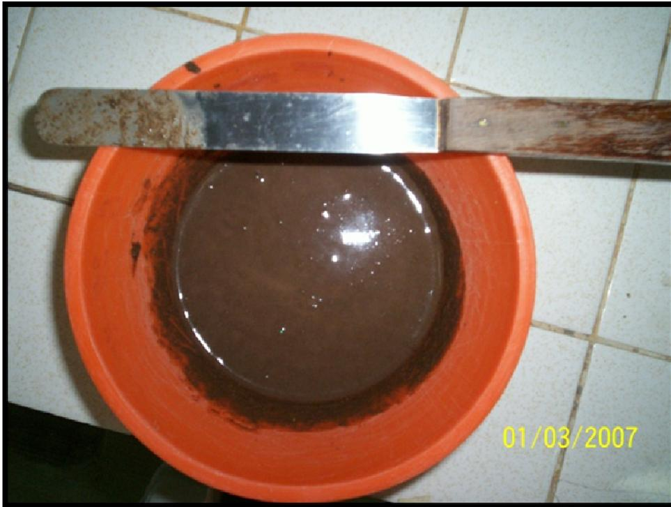
Figura 11-a. Pasta de saturación del suelo
